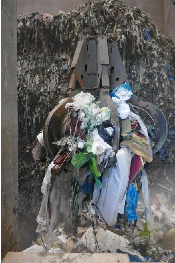
Mit dem Greifarm wird der Abfall in den Ofen gehievt Das Feuer brennt 365 Tage und Nächte ohne Unterbruch...
