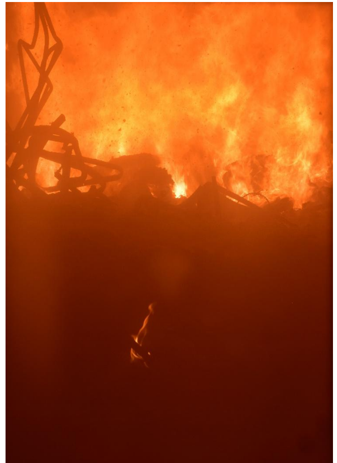
Mit dem Greifarm wird der Abfall in den Ofen gehievt Das Feuer brennt 365 Tage und Nächte ohne Unterbruch...
