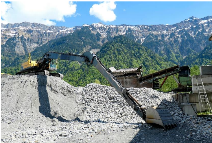
Der Aushub wird in 3 Stufen sortiert: Sand, feiner Kies und grober Kies
