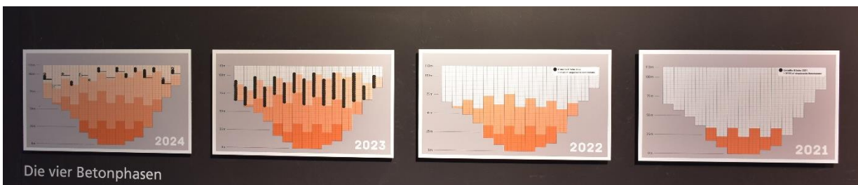
Die Mauer wurde im «Lego-Prinzip» gebaut.
