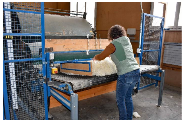
Als Nächstes zeigt uns Ruth Brog die grosse Kardiermaschine. Dort wird die Wolle über viele verschiedene Rollen mit Stahlhäkchen zu einem breiten Vlies gekardet.
