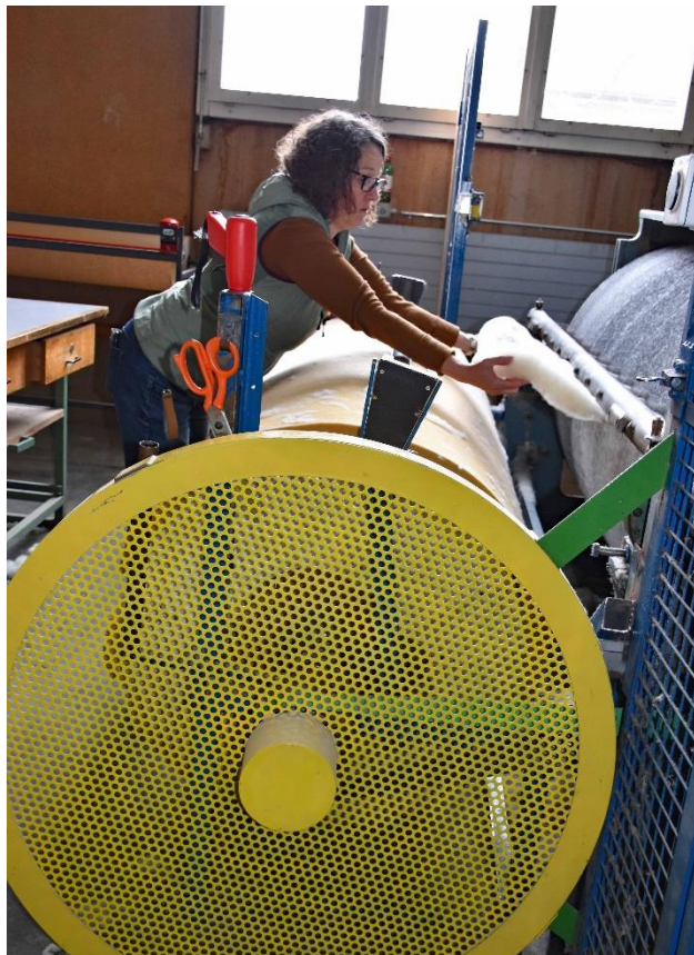
Als Nächstes zeigt uns Ruth Brog die grosse Kardiermaschine. Dort wird die Wolle über viele verschiedene Rollen mit Stahlhäkchen zu einem breiten Vlies gekardet.
