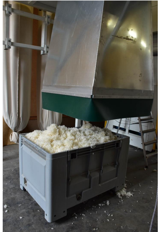
Die neueste Anschaffung im WollReich ist die teure «Woll-Kugeli-Maschine». Die Kugeli dienen als Füllmaterial für viele verschiedene Produkte.
