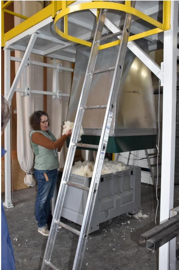
Die neueste Anschaffung im WollReich ist die teure «Woll-Kugeli-Maschine». Die Kugeli dienen als Füllmaterial für viele verschiedene Produkte.
