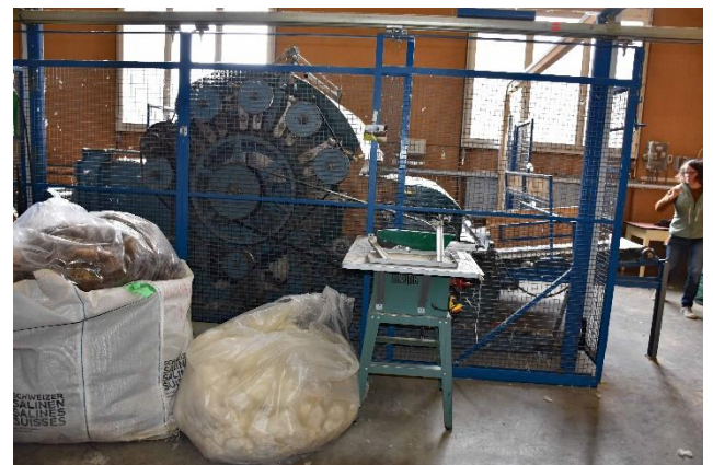
Die neueste Anschaffung im WollReich ist die teure «Woll-Kugeli-Maschine». Die Kugeli dienen als Füllmaterial für viele verschiedene Produkte.
